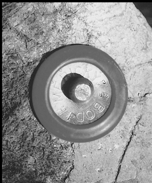
Měřičské body s vyraženým evidenčním číslem a iniciály HP, používané v r. 2005 při evidenci závrťů na Habrůvecké plošině.
