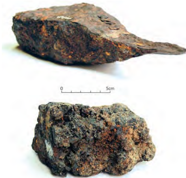
Obr. VIII.34. Čočkovitý polotovár/meziprodukt (nahoře) a skovaná vytavená houba (dole) (foto L. Plchová a A. Přichystal).
