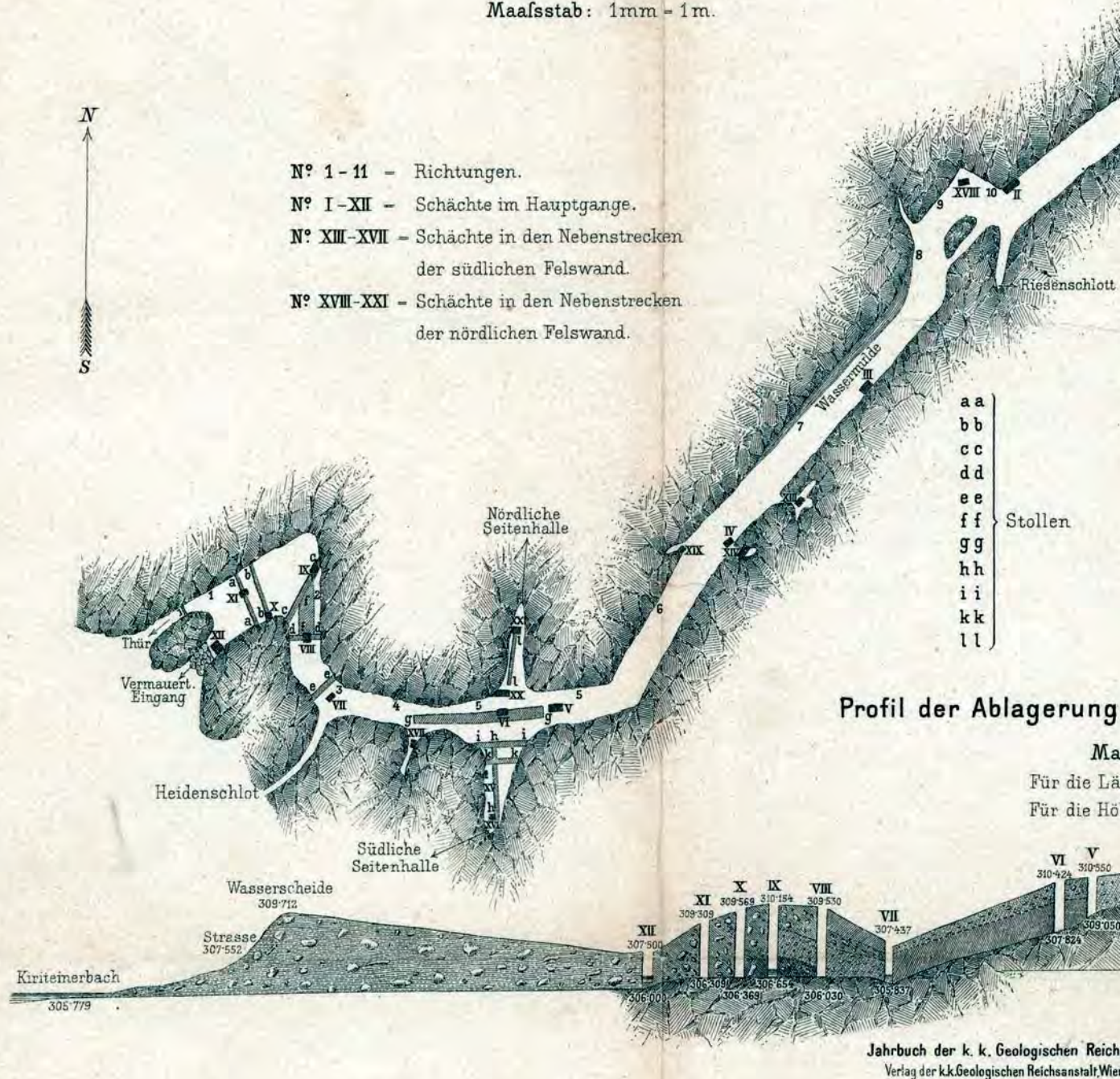
Obr. IX.P7. M. Kríž 1892: Jsou patrné provedené výkopy, schematizovaný zakres stěn a nivelované nadmořské výšky, 80 % původní velikosti (Kríž 1892).
